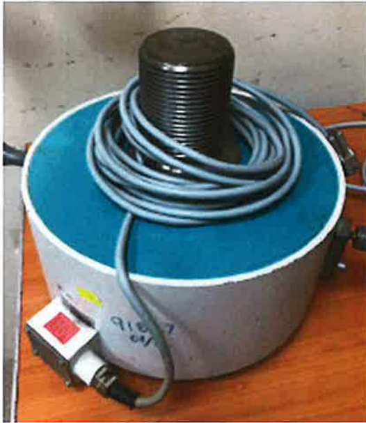
Celda ZA4/500 kN Marca: HBM Modelo: ZA4 Serie: 134630001 Puntos de Calibración: 0 kN a 500 kN Modo de calibración: Compresión/Tracción.
