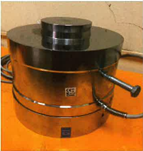
Celda C18/ 3 MN Marca: HBM Modelo: C18 Serie: 0028A50D Puntos de Calibración: 0 kN a 3 000 kN Modo de calibración: Compresión.
