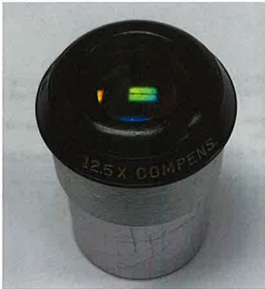
Escala patrón, regla graduada Marca: B & L Identificación: 660D-01 Alcance de medición: 0 mm a 10 mm
