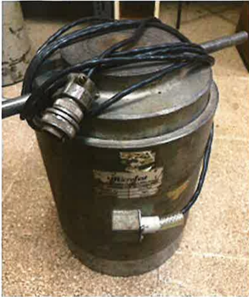
Celda PCC/500T / 5 MN Marca: Microtest Modelo: PCC/500T Serie: G50001 Puntos de Calibración: 0 kN a 5 000 kN Modo de calibración: Compresión.
