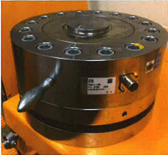
Celda C15/ 1 MN Marca: HBM Modelo: C15 Serie: 031588S Puntos de Calibración: 0 kN a 1 000 kN Modo de calibración: Compresión.
