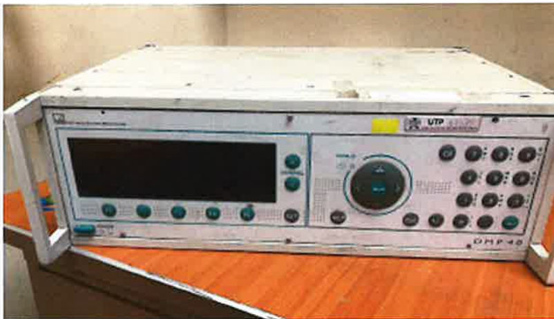
Indicador Digital DMP40 Marca: HBM Modelo: DMP40 Serie: 104920002
