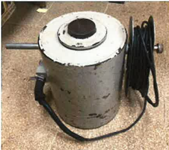
Celda C1/1 MN Marca: HBM Modelo: C1 Serie: 46433 Puntos de Calibración: 0 kN a 1 000 kN Modo de calibración: Compresión.
