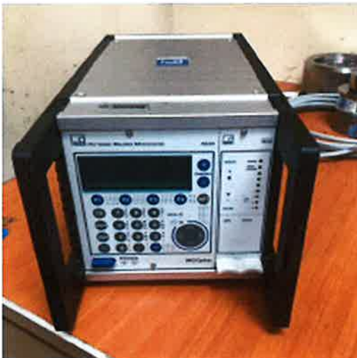
Indicador digital Marca: HBM Modelo: MGCPLUS Serie: 801407866003
