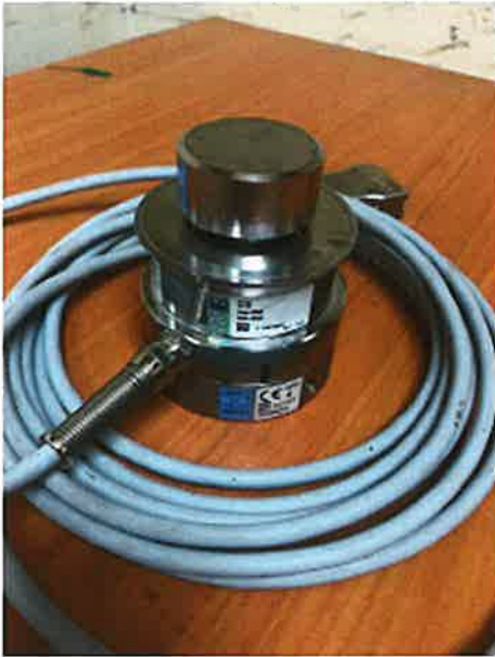
Celda C18/100 kN Marca: HBM Modelo: C18 Serie: 00289ZYI Puntos de Calibración: 0 kN a 100 kN Modo de calibración: Compresión.
